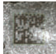
刮傷造成的部份破損
